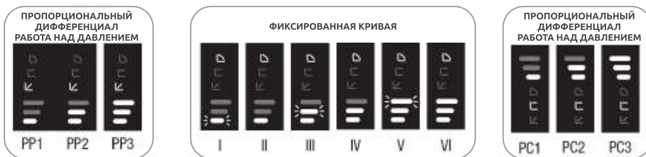
Рисунок 9 – Характеристики насоса DAB EVOSTA2 65/130 OEM для режимов.
